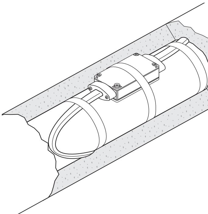
PMKG-LSC是用于自调控伴热线BTV、CTV、QTVR、RTV的两通接线盒，符合IEC标准。安装时固定于管道上，外面包有保温层，两通连接所用材料均可放于盒内。
