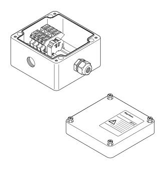
JB1-C是经过NEPSI认证的用于危险区域的电源接线盒。此单进线接线盒用来连接电力电缆、伴热线和冷端线。根据系统的配置情况,接线盒可以容纳一根伴热线/冷端线和一根电力电缆。通过DIN导轨固定的笼式弹簧夹接线端子来完成电缆的连接。通过盒子底部的四个安装孔,该接线盒既可以固定在墙壁上也可以固定在管道上。采用其中1个标准托架来固定管道。
