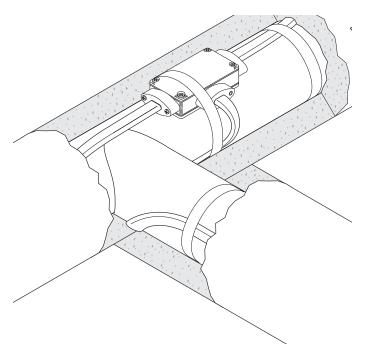
PMKG-LTC是用于自调控伴热线BTV、CTV、QTVR、RTV的三通接线盒,符合IEC标准。安装时固定于管道上,外面包有保温层,三通连接所用材料均可放于盒内。
